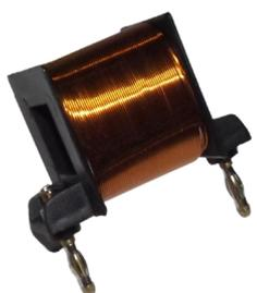
Kawat tembaga diameter 0,5 mm dililit rapih pada gulungan plastik ABS atau Polycarbonat dengan terminal steker kuningan divernikel lengkap dengan spring hull sistem 4 mm dengan jarak sistem 50 mm. Dapat dipasang pada Papan Rangkaian dan dirangkai dengan Inti Besi U-I dan Kumbaran yang lain membentuk trafo dengan perbandingan tegangan sama dengan perbandingan lilitan
