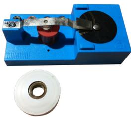
Perangkat pengetik waktu terpasang permanen pada kotak terbuat dari plastik ABS yang dapat ditancapkan pada Tumpukan Berpenjepit untuk dipasang pada Rel Presisi.
