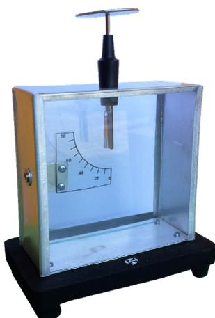
Berfungsi untuk memperlihatkan proses pemberian muatan listrik secara induktif dan semipermanen, serta menunjukkan sifat-sifat interaksi antar benda bermuatan listrik.
