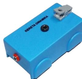
Ukuran Kereta 94 x 47 x 36 mm. Tinggi dengan roda 42 mm. Kereta dari plastik dicat, tebal dinding 1,7 mm dilengkapi 4 roda plastik ABS, berpenjepit. Di bagian atas, belakang dan depan terdapat lubang sistem 4 mm. Roda dapat berputar lancar bersama porosnya dengan menggunakan sistem poros arloji, kompatibel dengan rel presisi. Posisi bibir roda
