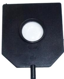
Lensa : Optical Glass, jarak fokus lensa + 50 mm. Bahan bingkai dari plastik ABS warna hitam dengan tiang penyangga diameter 8 mm.
