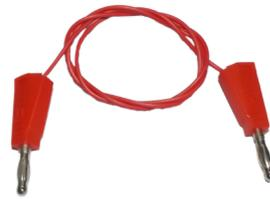
Kabel penghubung berinti serabut kawat tembaga halus terisolasi plastik merah lentur. Panjang 50 cm, arus maks 8A. Berisi 56 kawat tembaga lengkap dengan steker sistem diameter 4 mm dengan spring hull divernikel. Steker tertancap kokoh pada rumah plastik warna merah yang bagian atasnya terdapat soket diameter 4 mm untuk menumpuk steker (menambah sambungan). Steker dapat dilepas dari rumahnya tapi tidak mudah lepas.
