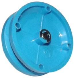
Bahan : Plastik ABS, diameter luar 58 mm, tebal bagian tepi 18 mm, diameter celah "V" 50 mm. Poros berpuli diameter 18 mm dengan celah "U" lengkap lubang melintang 4 mm yang kompatibel dengan batang perangkai, ujung poros berlubang
