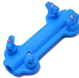
Bahan : Plastik ABS, panjang 100 mm, dengan 4 mur/baut dari kuningan yang ditanam dan 4 baut/mur pengencang mudah diputar tangan. Baut/mur pengencang divernikel, tidak dapat dilepas. Di tengah-tengah terdapat batas penyambungan,
