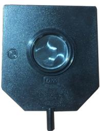
Bahan : Kaca cermin cekung, jarak fokus cermin +100 mm, dibingkai plastik ABS warna hitam dengan tiang penyangga diameter 8 mm.
