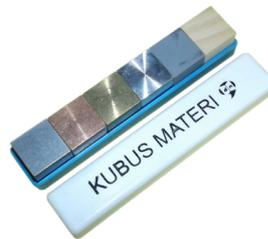
Ukuran kubus : 20 x 20 x 20 mm, dikemas dalam kotak plastik dengan penutup. Sisi-sisi kubus harus siku-siku, permukaan rata dan mulus.
