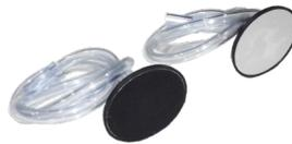
Terdiri dari detektor warna hitam dan putih. Sambungan antara membran dan detektor harus kedap udara. Bahan detektor plastik ABS dia 53 mm. Bagian membran plat aluminium, tebal 0,4 mm, warna hitam dan natural (warna asli aluminium). Selang plastik lunak transparan dengan diameter dalam selang 6 mm dan diameter luar 9 mm, serta panjang 450 mm.
