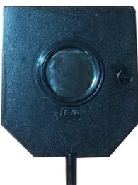
Bahan : Kaca cermin cembung, jarak fokus cermin-100 mm, dibingkai plastik ABS warna hitam dengan tiang penyangga diameter 8 mm.
