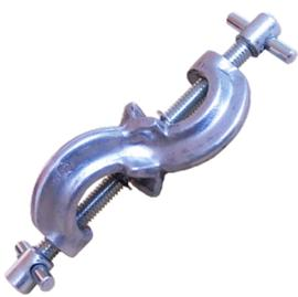
**Bahan** : Aluminium die casting. Celah bentuk V untuk 3 titik kontak pada batang yang berdiameter 2 sampai 13 mm, lengkap dengan 2 buah baut pengencang dari logam divernikel atau stainless steel, baut tidak mudah lepas dan pada bagian ujung di Champer
