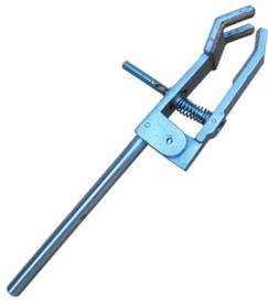
**Bahan** : Aluminium die casting, dengan batang dari stainless steel (tak tertarik magnet). Dapat menjepit benda dengan diameter 2 mm - 70 mm. Pada ujung dilapis cork/gabus tebal 2-4 mm.
