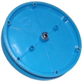
Bahan : Plastik ABS, diameter luar 108 mm, tebal bagian tepi 18 mm, diameter celah "V" 50 mm. Poros berpuli diameter 18 mm dengan celah "U" lengkap lubang melintang 4 mm yang kompatibel dengan batang perangkai, ujung poros
