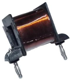
Kawat tembaga diameter 0,5 mm dililit rapih pada gulungan plastik ABS atau Polycarbonat dengan terminal steker kuningan divernikel lengkap dengan spring hull sistem 4 mm dengan jarak sistem 50 mm. Dapat dipasang pada Papan Rangkaian dan dirangkai dengan Inti besi U-I dan Kumbaran yang lain membentuk trafo dengan perbandingan tegangan sama
