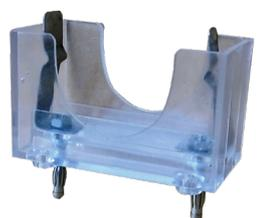
Bahan : Plastik transparan polycarbonate, dengan steker sistem diameter 4 mm dengan spring hull divernikel, jarak steker sistem 50 mm.
