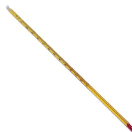
Berisi Alkohol merah, panjang sekitar 300 mm, dengan lubang penggantung, lengkap dengan wadah/rumah penyimpanan, akurasi 2° C. Alkohol tidak "terputus" bila terjadi perubahan suhu mendadak. Pada termometer terpasang "stopper" agar tak dapat bergulir bebas ketika diletakkan pada bidang datar. Skala permanen dan jelas dengan skala 1 derajat.
