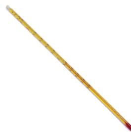
Berisi Alkohol merah, panjang 300 mm, dengan lubang penggantung, lengkap dengan wadah penyimpanannya, akurasi 4° F. Alkohol tidak "terputus" bila terjadi perubahan suhu mendadak. Pada termometer terpasang "stopper" agar tak dapat bergulir bebas ketika diletakkan pada bidang datar. Skala permanen dan jelas dengan skala 2 derajat.
