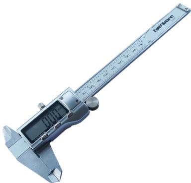
Jangka sorong digital untuk pengukuran diameter luar, diameter dalam dan kedalaman
