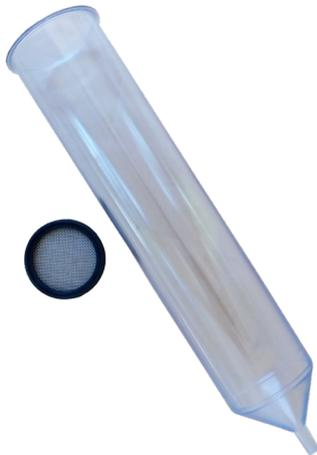
Bahan plastik tranparan (SAN), diameter 60 mm, tinggi 300 mm, tebal 2 mm. Dilengkapi dengan kasa Stainless kuat berbingkai untuk menahan pasir, dipasang di dasar tabung. Di bagian tengah dasar tabung terdapat lubang berpipa dengan diameter luar 8 mm, panjang pipa 15 mm, kompatibel dengan selang plastik.
