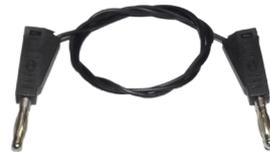
Kabel penghubung berinti serabut kawat tembaga halus terisolasi plastik hitam lentur. Panjang 50 cm, arus maks 8A. Berisi 56 kawat tembaga lengkap dengan steker sistem diameter 4 mm dengan spring hull divernikel. Steker tertancap kokoh pada rumah plastik warna hitam yang bagian atasnya terdapat soket diameter 4 mm untuk menumpuk steker (menambah sambungan). Steker dapat dilepas dari rumahnya tapi tidak mudah lepas.
