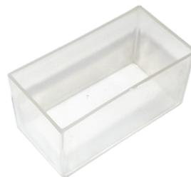
Bak plastik bening ukuran 60 x 30 x 30 mm (p x l x t) tebal 1,2 mm, digunakan untuk menentukan indeks bias zat cair.
