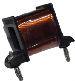
Kawat tembaga diameter 0,5 mm dililit rapih pada gulungan plastik ABS atau Polycarbonat dengan terminal steker kuningan divernikel lengkap dengan spring hull sistem 4 mm dengan jarak sistem 50 mm. Dapat dipasang pada Papan Rangkaian dan dirangkai dengan Inti besi U-I dan Kumbaran yang lain membentuk trafo dengan perbandingan tegangan sama
